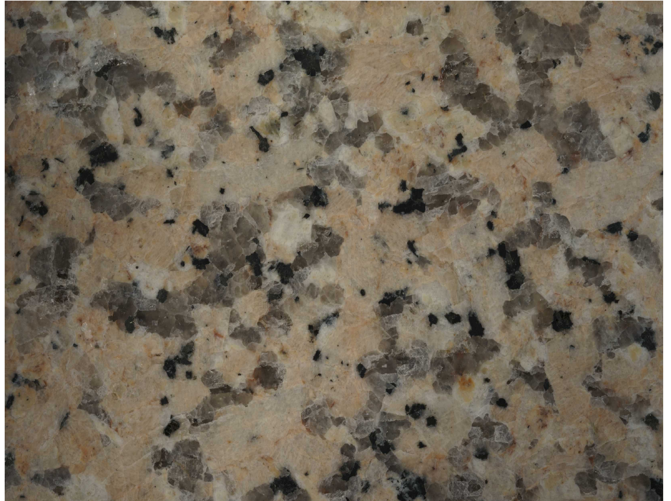
Granit besteht aus den Mineralien Quarz (grau), Feldspat (weiß – rosafarben) und Glimmer (schwarz), Bildbreite 10 cm
